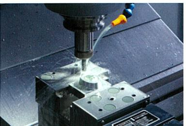
マシニング、NCフライス、横型フライスなどを用いて様々な製品を作り出します。制御付インデックステーブルを設備していますので螺旋形状の加工なども行います。また3Dデータを用いた3D加工も行います。
