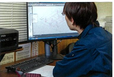
様々な異形状の製品のプログラムを作成します。お客様から頂いた図面から3Dデータを起こし、プログラムを作成し機械加工を行います。また型彫り放電加工時に使用する電極作製にも多く使用します。
