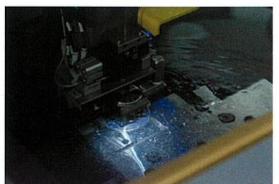
切削加工では対応できない形状や熱処理後の高硬度ワークへの加工時に放電加工機を用いて加工します。ワイヤー放電加工機と型彫放電加工機があり、型彫放電加工に使用する電極も社内にて製作するので納期短縮に繋がっております。
